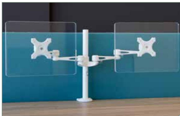
DUBBELE MONITOR-ARM. MET BLADKLEM. STAAL, IN ALU, WIT OF ZWART. TOT MAX. 14 KG MONITORGEWICHT MAX. 28" MONITOREN NMA2.
